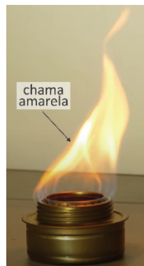
(I) Chama na presença de solução de NaCl.
